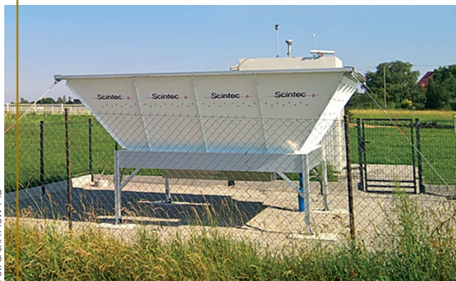
Antena nadawcza WP LAP3000 w Raciborzu. Obecnie w Unii Europejskiej i krajach NATO działają 34 tego typu urządzenia. Zakup Wind Proflera zrealizowano w ramach projektu ACTRIS finansowanego ze środków Europejskiego Funduszu Rozwoju Regionalnego – Programu Operacyjnego Inteligentny Rozwój 2014–2020 (POIR).
